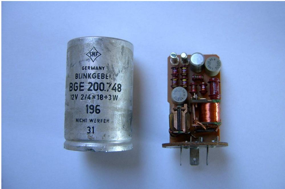
Moderne Blinkrelais besitzen eine elektronische Steuerung und sind technisch gesehen normale Relais mit Ansteuerschaltung. Durch die gemeinsame Anordnung von Elektronik und Relais in einem Gehäuse werden sie jedoch auch als Blinkrelais bezeichnet. Diese Bauform findet in Kraftfahrzeugen seit Jahren Verwendung.
